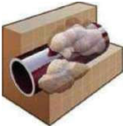
Muestra de la inyección polimerizada que penetra desde dentro hacia el exterior de la canalización.
